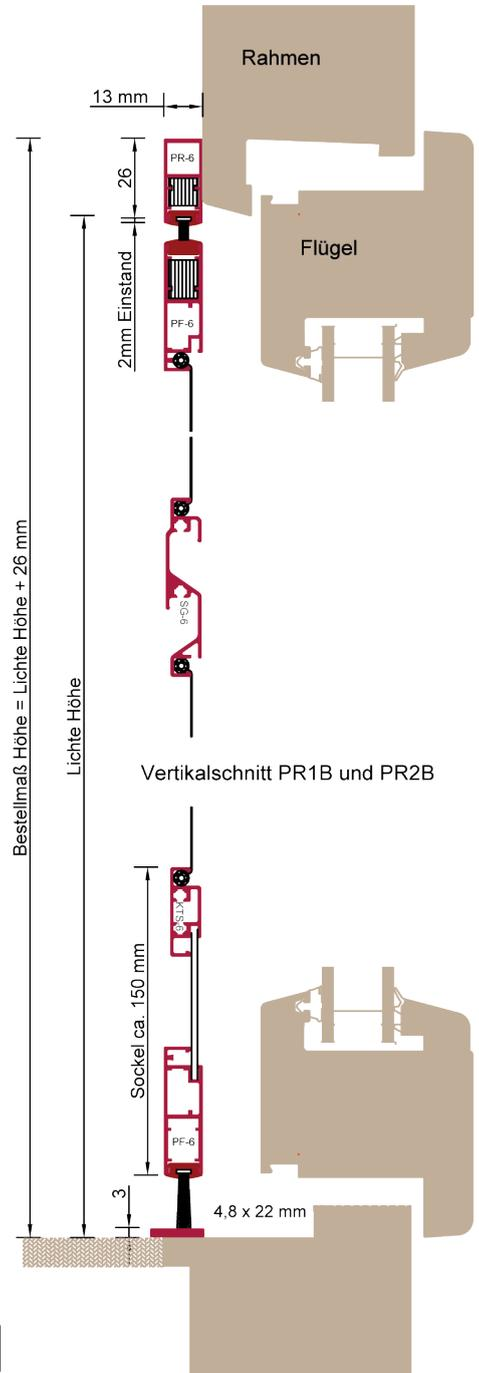
Vertikalschnitt PR1B und PR2B
