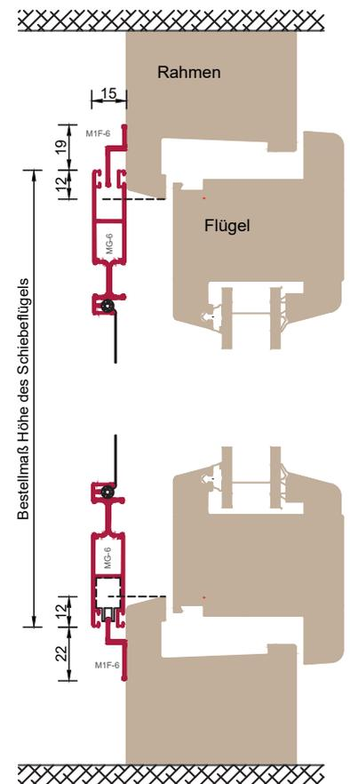
Variante MF-11-MG mit Führungsschiene M1F oben und unten
