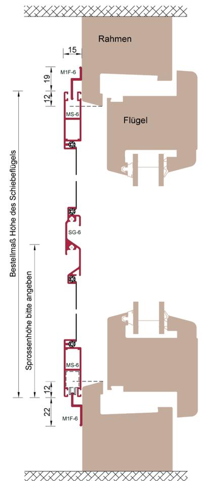
Variante MF-11-MS mit Führungsschiene M1F oben und unten
