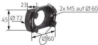
Kompakt-Antriebslager Sternkopf und Federring mit Öse, einsetzbar für Motoren mit 60er Welle bis 35 Nm Drehmoment, seitlicher Platzbedarf bei Behangbeginn min. 24 mm.
