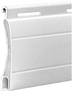
Aluminium-Rollladenpanzer Mini A37, mit Lichtschlitzen vorgesehen, arretiert, mit Aufhängefedern, mit Standard-Endleiste inkl. Keder, gebohrt nach Wahl, mit Stopfen (Standard: 40 mm) oder mit 1-teiliger Winkel-Endleiste.
